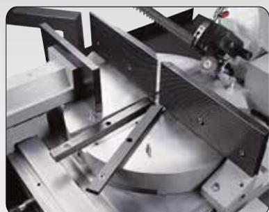
Plateau tournant sur roulement à billes
