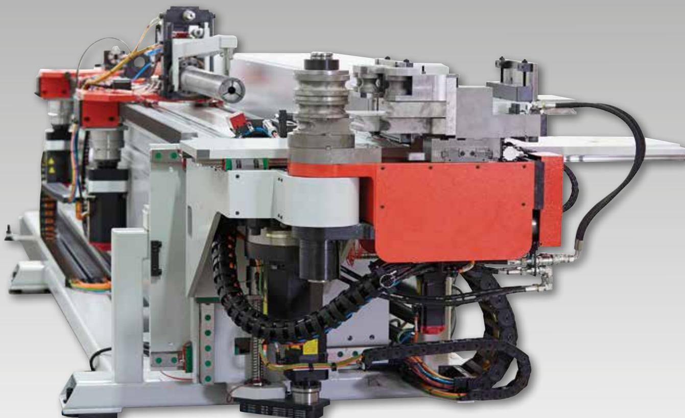
La série **électrohydraulique IZIBEND** est disponible en capacité 45/ 65 et 90 mm en configuration 3 et 5 axes.
