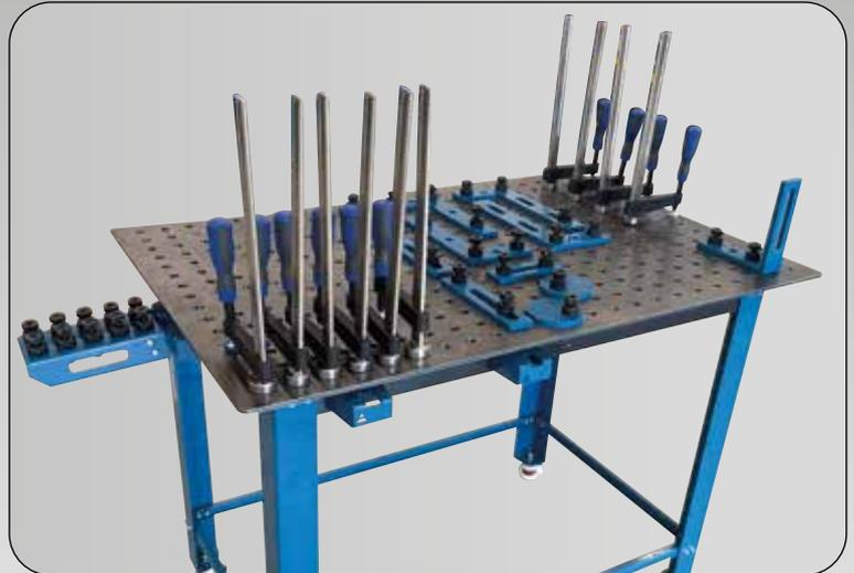
Les trous de fixation  $\varnothing 16$  mm dans la grille 50 x 50 mm et la graduation gravée dans la grille 100 x 100 mm permettent une **fixation précise et facile des outils et des composants**.
