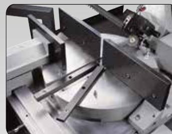
Plateau tournant sur roulement à billes
