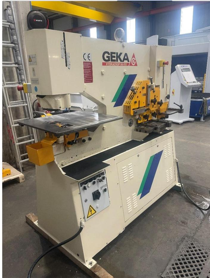
Poinçonneuse-cisaille GEKA HYDRACROP 55SD
