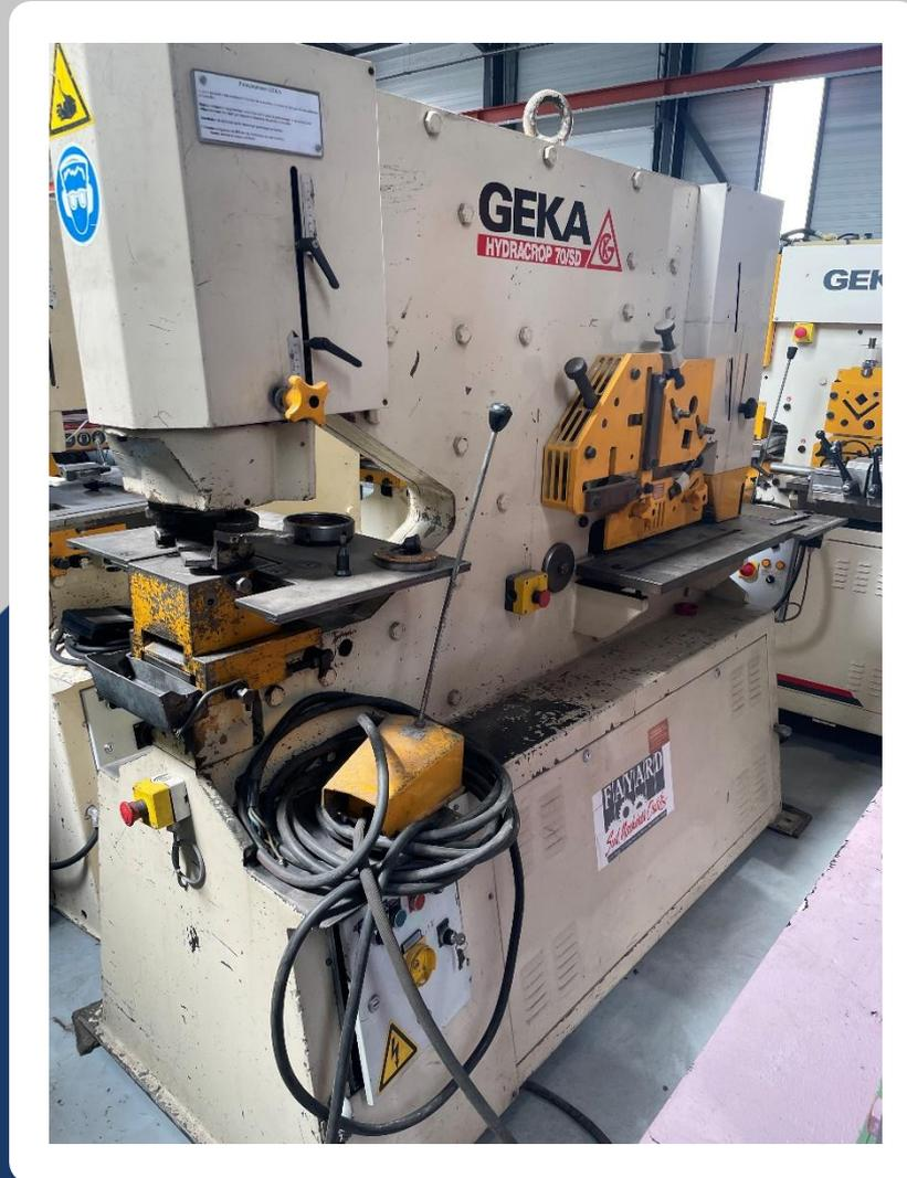
Poinçonneuse-cisaille GEKA HYDRACROP 70SD
