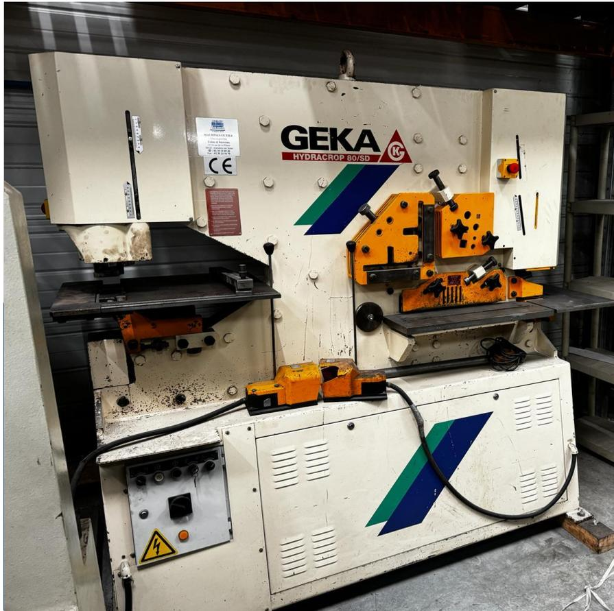
Poinçonneuse-cisaille GEKA HYDRACROP 80SD
